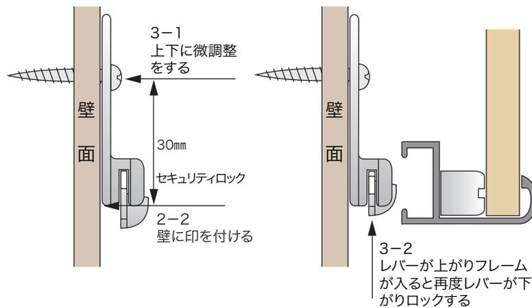
3. 再度パネルをホックに掛けてパネル下部のフレームの溝にロックがセット出来る様に微調整してビスをしっかりと固定する。完全に位置が決まったら下部のフレームをカチッと音がするまで押さえて完了。尚、一度セットされたパネルは、専用のセキュリティキーがなければ外す事が出来ません。尚、大型サイズの場合は、ロックを両側に使用される事をお勧めします。
