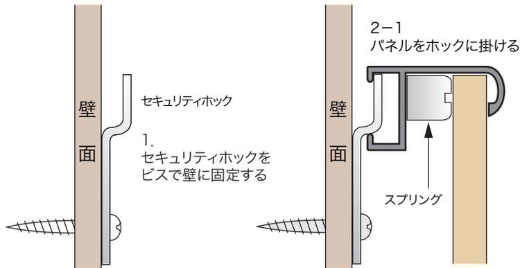
1. セキュリティホックをパネル上部の左右より10cm程度内側に入った所にビスで固定する。但し、この時に左右のホックの水平には十分注意して下さい。
